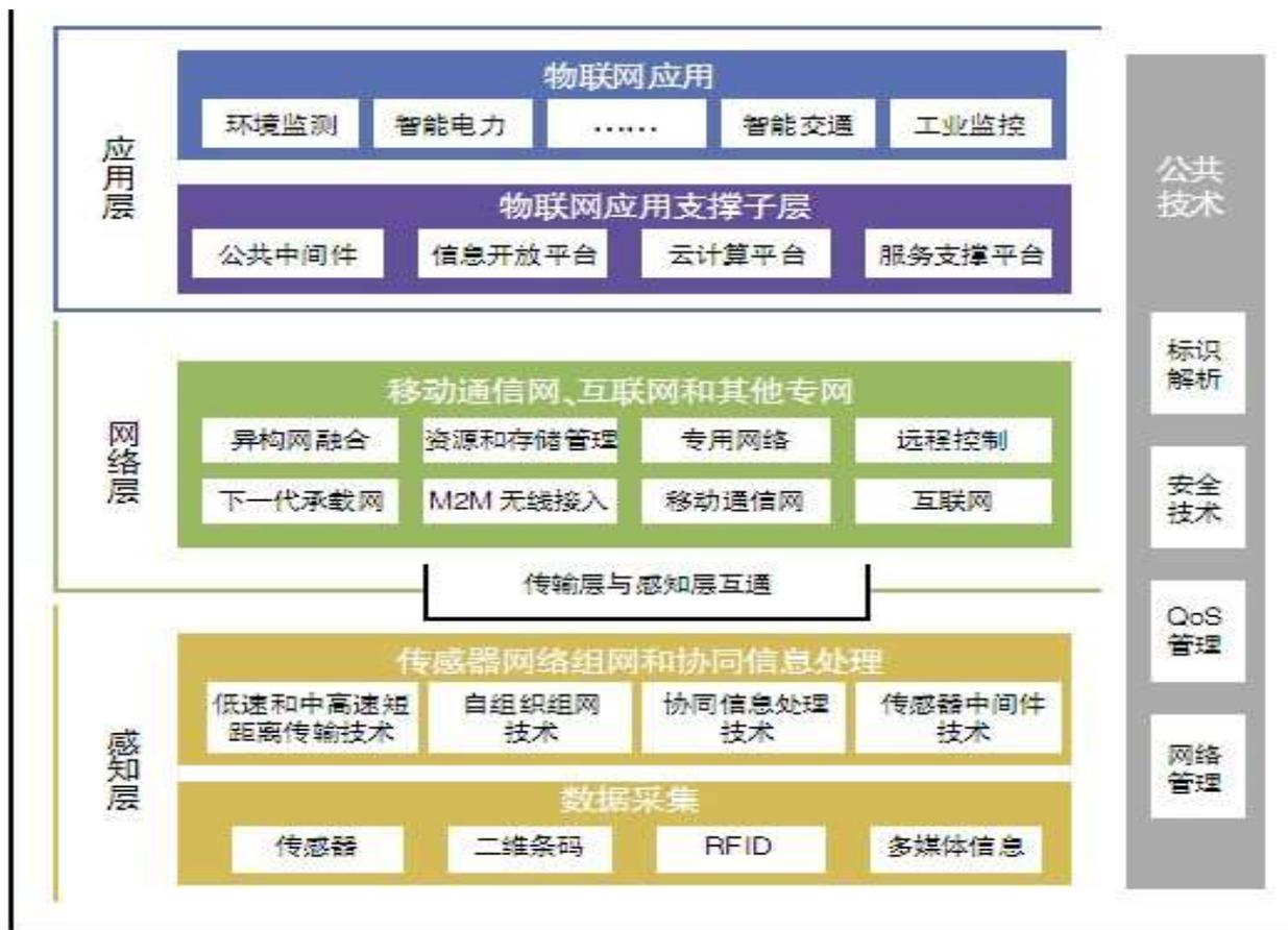
图 2:物联网的技术体系框架
